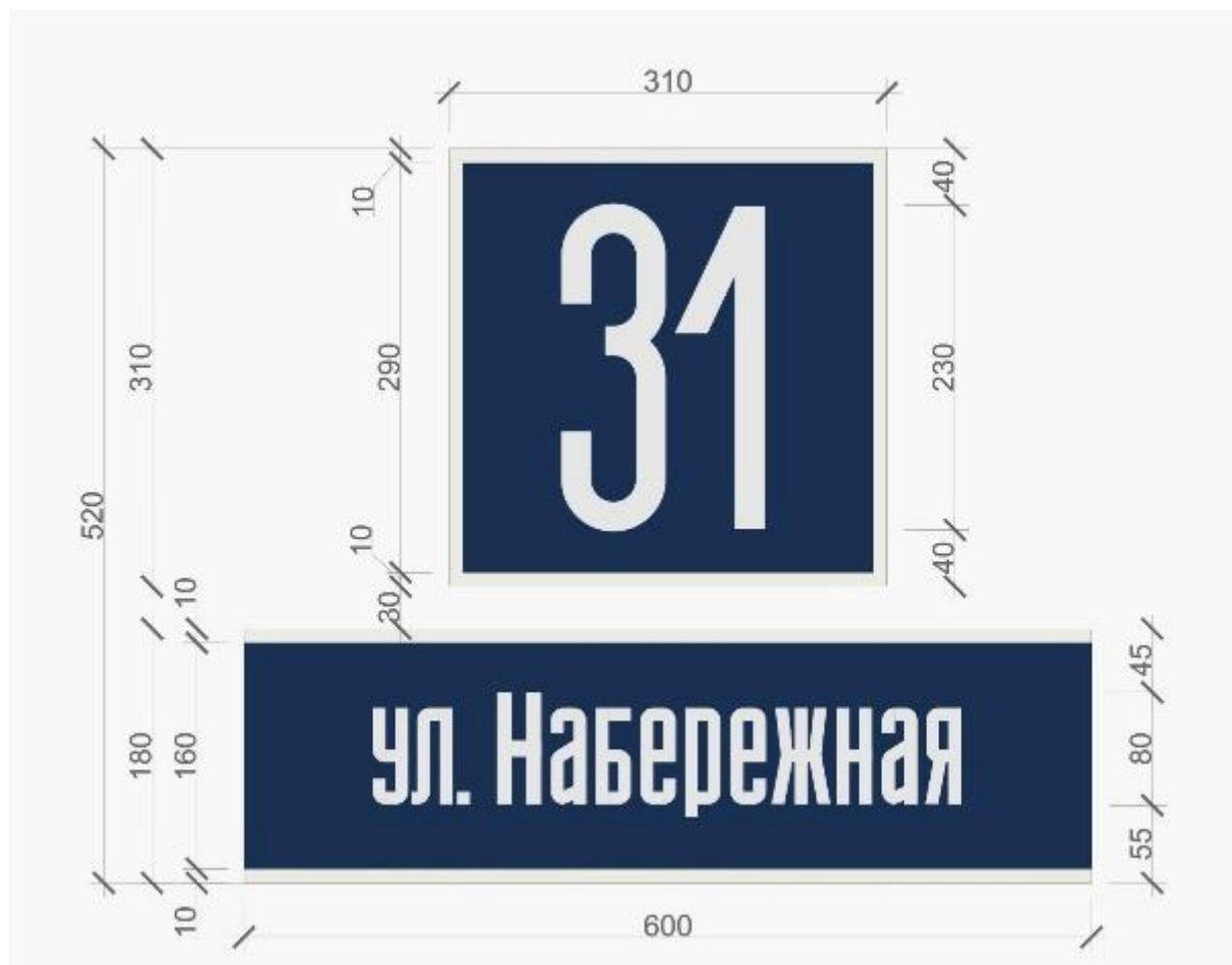
Рис. 47. Оформление домового знака вне границ территории исторического поселения регионального значения город Череповец (размеры указаны в миллиметрах).
