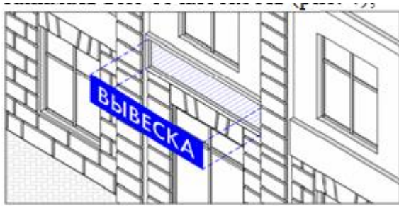
Рис. 4. Размещение вывески на подложке в нише
