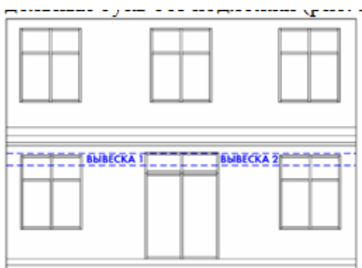
Рис. 9. Размещение вывески между проемами
