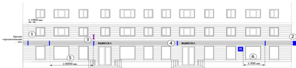
Рис. 24. Требования к размещению консольных конструкций
